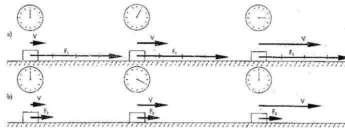
Fig. 9 - Se l'intensità della forza  $F_2$  è un quarto di quella della forza  $F_1$ , per produrre la stessa variazione di velocità impiegherà un intervallo di tempo 4 volte più lungo.
