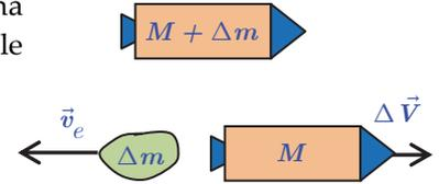
Dividendo per  $\Delta t$  si fanno comparire nell'equazione l'accelerazione media del razzo  $a = \Delta V/\Delta t$ , e la quantità di kilogrammi di carburante espulsa ogni secondo, cioè il *flusso di massa*  $\Delta m/\Delta t$ :
