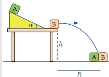
65. Una massa  $m_A = 5.00$  kg inizialmente ferma, scivola giù per un cuneo inclinato di  $\alpha = 35^\circ$  lungo  $L = 2.00$  m, posto sopra ad un tavolino alto  $h = 1.50$  m, perdendo il 30.0% dell'energia per attrito. In fondo al cuneo essa urta, in modo completa-
