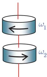
97. Due cilindri identici di massa  $m = 6.00 \text{ kg}$  e raggio  $R = 2.00 \text{ m}$  ruotano attorno al comune asse centrale in versi opposti, con velocità angolari la prima doppia della seconda, come in figura. Quando il primo viene fatto cadere sul secondo, le forze d'attrito, dissipando un'energia di  $100 \text{ J}$ , portano il sistema ad una stessa velocità angolare finale. Si calcoli il suo valore. [R: 1.32 rad/s]
