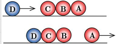
Per capire cosa accade, supponiamo che A, B e C non si tocchino, ma che vi sia fra loro una piccola distanza di separazione. In tal caso abbiamo visto che quando D urta C si scambiano le velocità e C riparte con la velocità di D. Analogamente C scambia la sua velocità con B e si arresta, ed infine B si arresta scambiandola con A, che riparte alla velocità originaria. Il meccanismo è analogo se le sfere sono a contatto, e non dipende dal numero di sfere coinvolte.
