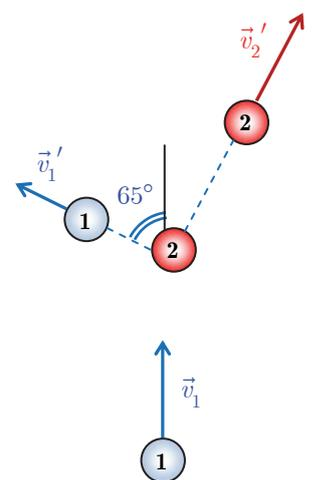
Con riferimento al disegno, sappiamo che le velocità  $\vec{v}'_1$  e  $\vec{v}'_2$  con le quali due sfere di uguale massa escono dall'urto sono perpendicolari. Quindi la seconda palla si mette in moto ad un angolo di  $90.0^\circ - 65.0^\circ = 25.0^\circ$ .
