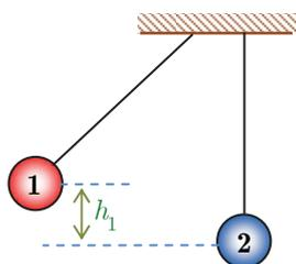
56. Due sfere di masse  $m_1$  ed  $m_2 = 2m_1$  sono sospese per due fili della stessa lunghezza e formano due pendoli che si toccano in posizione di riposo. La sfera  $m_1$  viene sollevata ad un'altezza  $h_1 = 15.0 \text{ cm}$  e lasciata andare da ferma, ed urta elasticamente  $m_2$  nel punto più basso. Calcolare le altezze massime a cui risalgono entrambe dopo l'urto.
