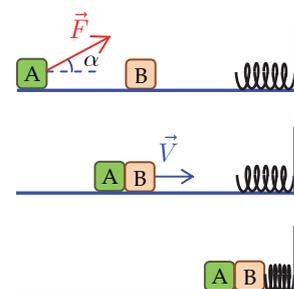
64. In un urto completamente anelastico fra due blocchetti di masse  $m_A = 4.50$  kg ed  $m_B$ , l'incremento di energia interna del sistema è  $100$  J. Sapendo che prima dell'urto le due masse procedevano l'uno contro l'altro a velocità  $v_A = 5.00$  m/s e  $v_B = -3.00$  m/s, calcolare  $m_B$ .
