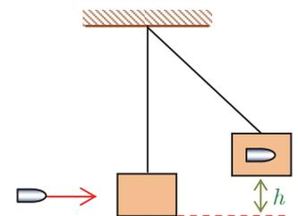
L'urto è completamente anelastico: lungo un asse orizzontale orientato a destra, indichiamo con  $v$ ,  $V'$  le componenti delle velocità del proiettile prima dell'urto e del pendolo immediatamente dopo l'urto, ed imponiamo la conservazione della quantità di moto:
