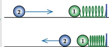
59. Un proiettile di massa  $m = 10.0$  g si conficca in un blocchetto di massa  $M = 5.000$  kg agganciato ad una molla orizzontale in posizione di riposo, che si comprime di  $x = 6.00$  cm e poi oscilla con un periodo di  $1.50$  s. Calcolare la velocità che aveva il proiettile.
