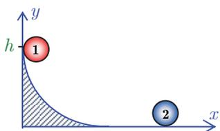
55. Una sferetta di massa  $m_1 = 2.50 \text{ kg}$  viene lasciata cadere da un'altezza  $h = 5.00 \text{ m}$  lungo un guida curva che l'accompagna su di un piano, dove urta elasticamente una seconda sfera di massa  $m_2 = 4.50 \text{ kg}$ . Si calcoli la velocità con cui  $m_2$  si mette in moto e l'altezza alla quale risale  $m_1$  lungo la guida.
